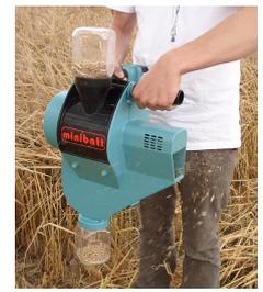
10. МИНИБАТТ снабжен декой молотильного барабана 5 x 20 со съёмной сеткой остеотделителя специально для пшеницы и ячменя. **Необходимо снять сетку остеотделителя**, если у зерна нет ости или в пробу попало пленчатое зерно. Применение сетки остеотделителя **повышает** чистоту зерна, но **снижает** производительность машины.
