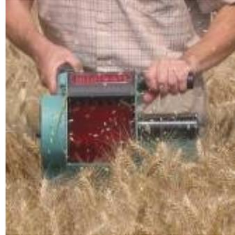
2. Установите МИНИБАТТ в **вертикальное положение** и опустите его до уровня колосьев, крышка захватывающего устройства должна быть открыта. Не рекомендуется перемещать МИНИБАТТ вперед во время отбора пробы.
