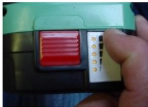
Батарея прибора оборудована индикатором уровня заряда. Чтобы определить уровень заряда, нажмите при включенном двигателе на кнопку, как показано на рисунке. Лампочки показывают уровень заряда: 5 горящих оранжевых лампочек свидетельствуют о полной зарядке батареи. Одна оранжевая лампочка свидетельствует о том, что вскоре батарею необходимо будет зарядить. Если горят 2 красных лампочки, батарея требует подзарядки.
